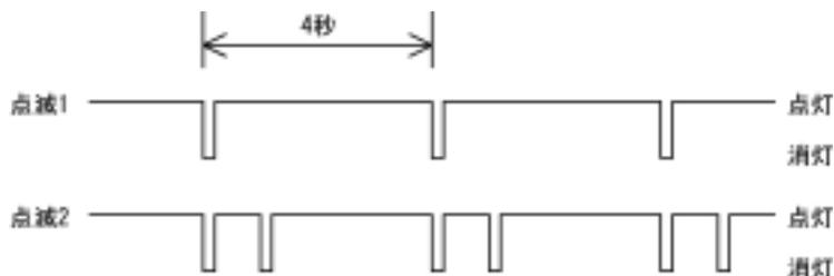
スタート/ストップおよびタリー信号は、コネクタ内に収められたマイコンにより処理されています、特にタリーランプは、それぞれのVTRの状態がわかるようになっていています(左図参照)(使用例、下図参照)。
