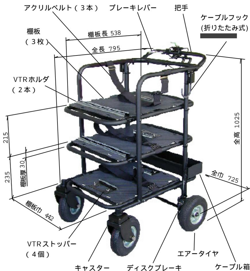
VTC-150は全輪をエアータイヤ(223ミ外径)にしたことにより重い精密機械を搭載した場合も走行時の振動を吸収して安全に移動することができます。
